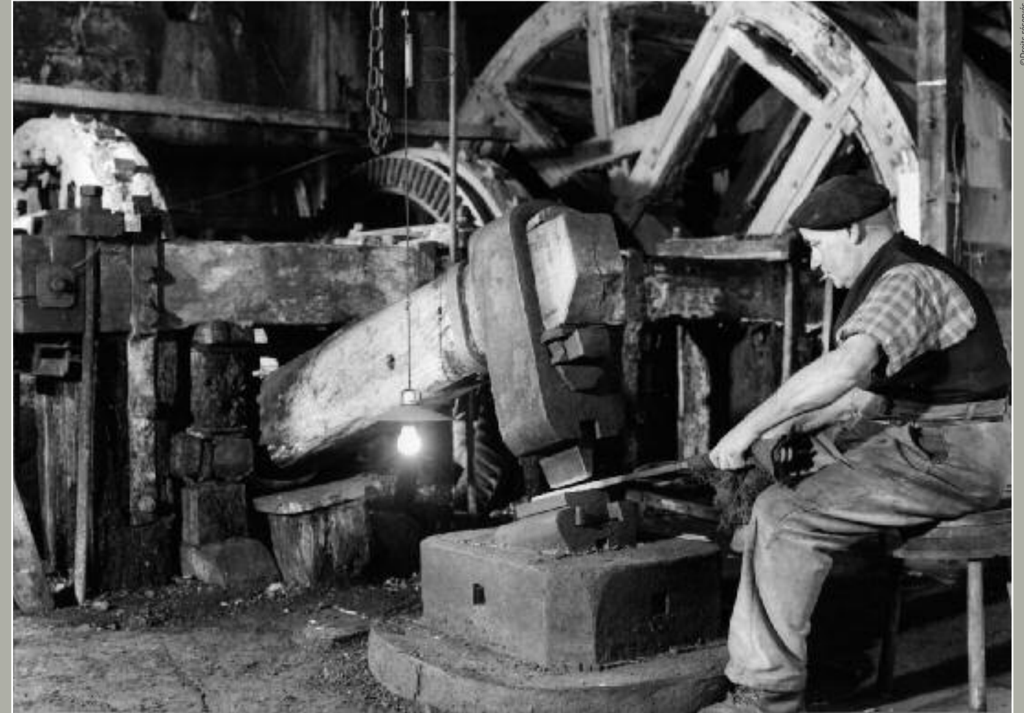
Taillanderie de Nans-sous-Sainte-Anne, Doubs : travail au martinet, Auguste Philibert élargit une faux sous le marteau.
